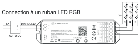
Connection à un ruban LED RGBW
